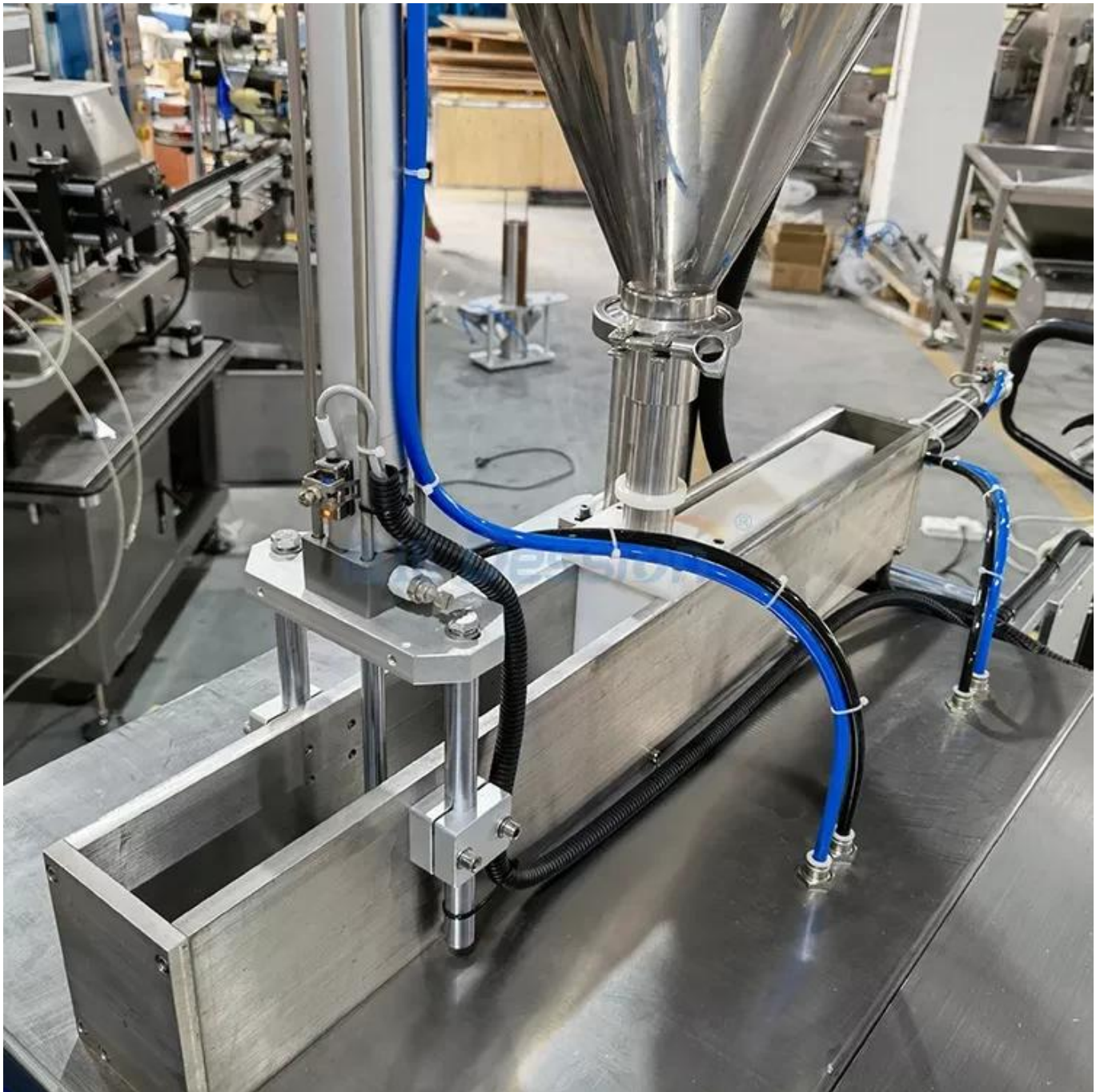
Befüllung mit pneumatischer Pumpe
