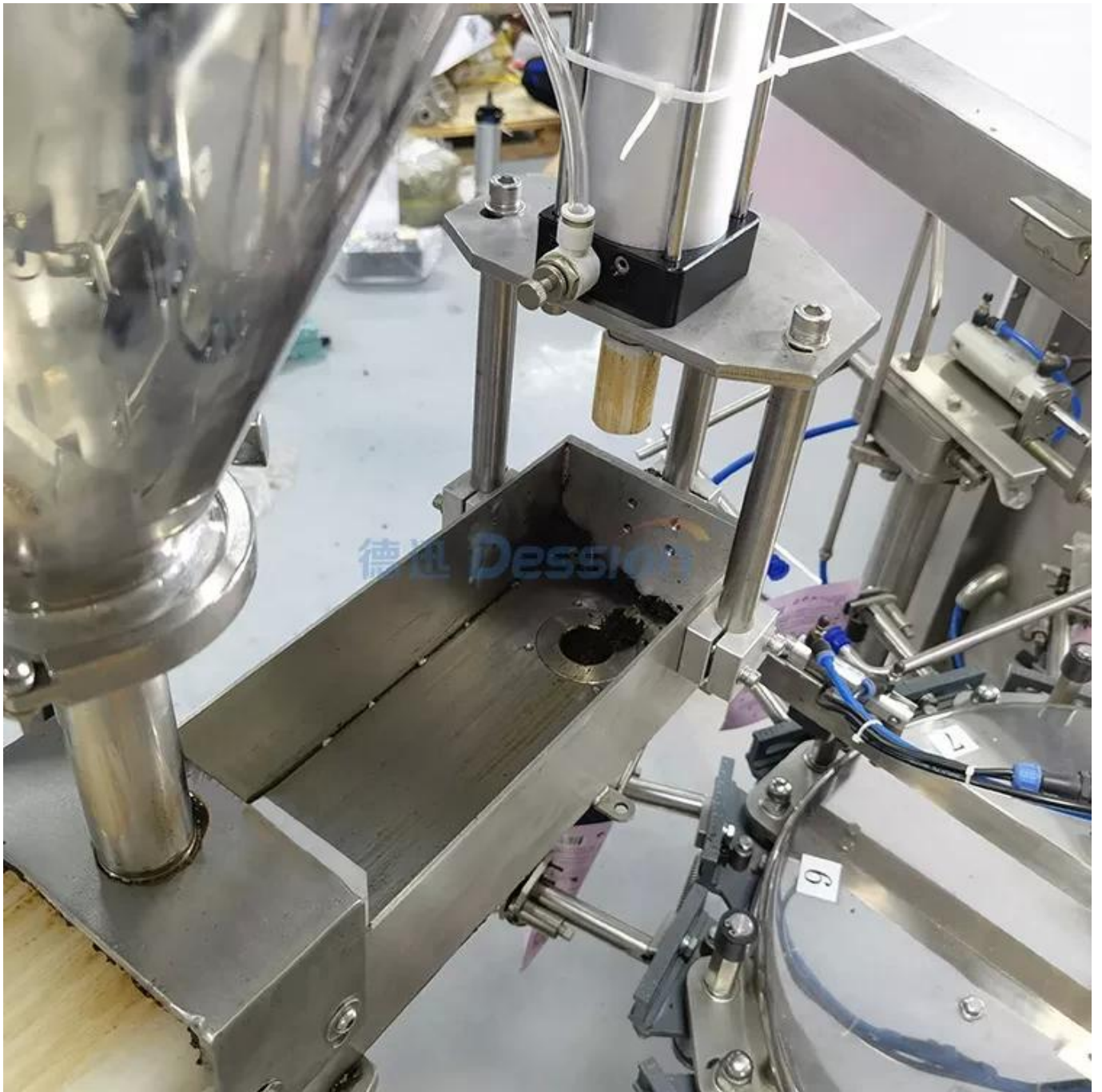
Befüllung mit pneumatischer Pumpe
