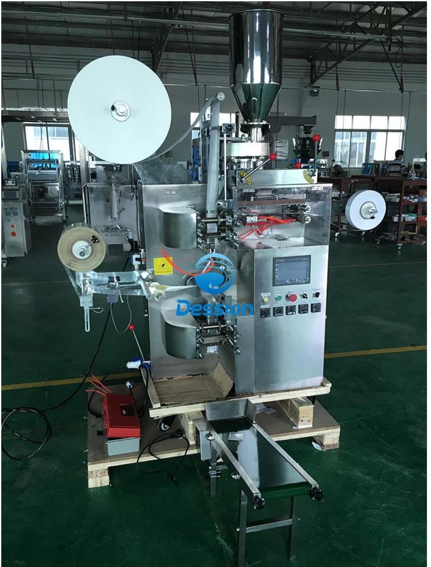
Sachet-Beutel der Tee-Verpackungsmaschine für Dip Teebeutel
