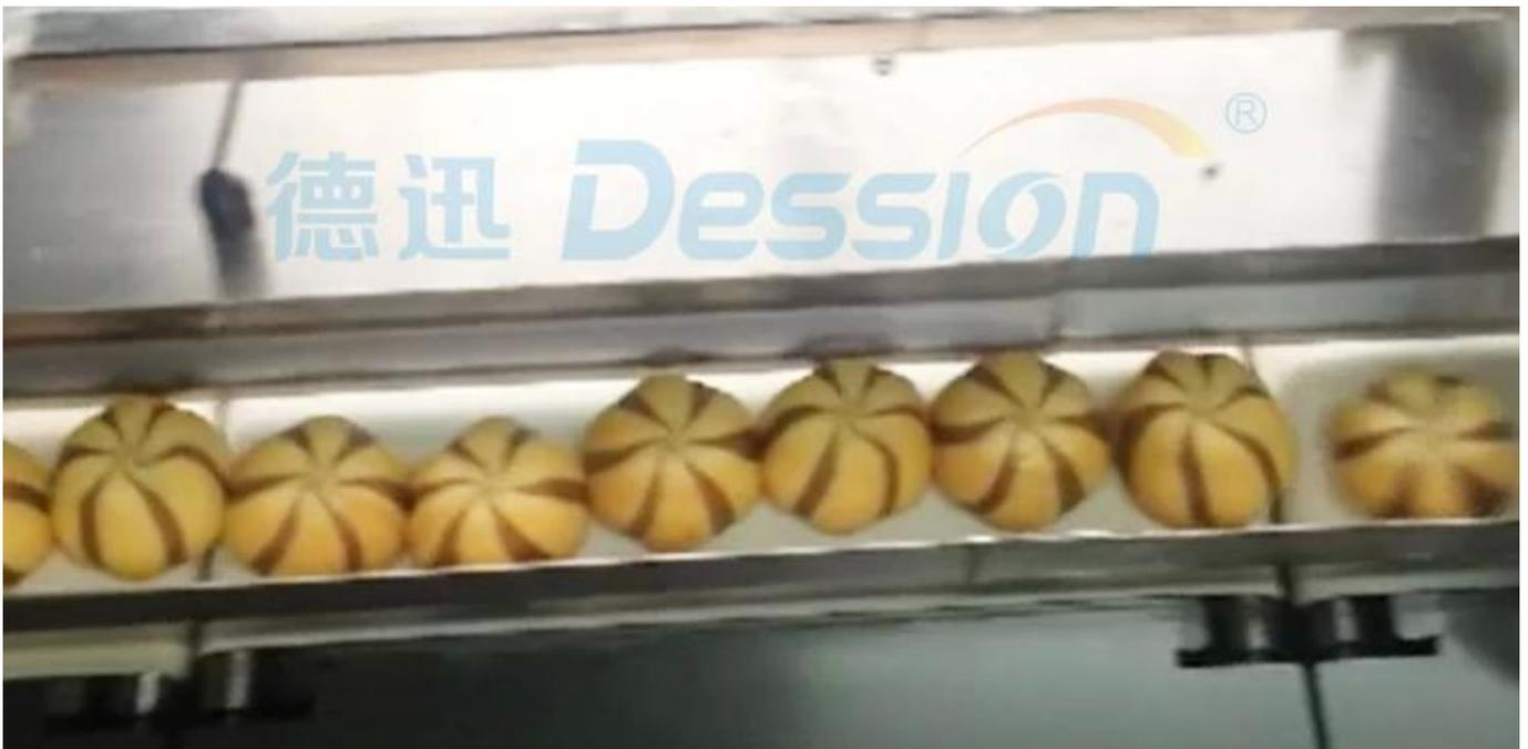
**3. Verpackter Artikel geht von der Drehplatte zum Beutelformgerät**
