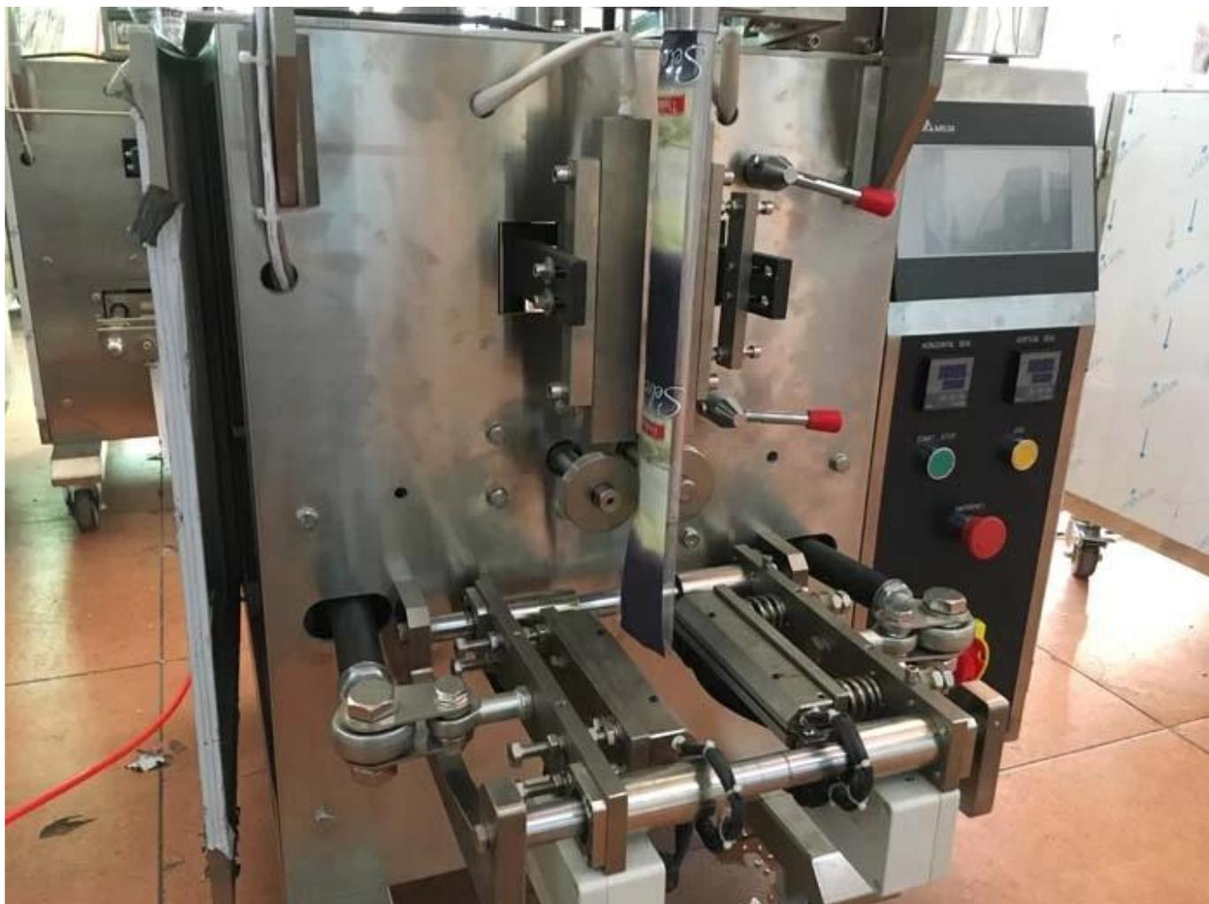
IMPRESORA DE DATOS, IMPRIME AUTOMÁTICAMENTE LA FECHA DE PRO. Y EXP. FECHA EN LA BOLSA.
