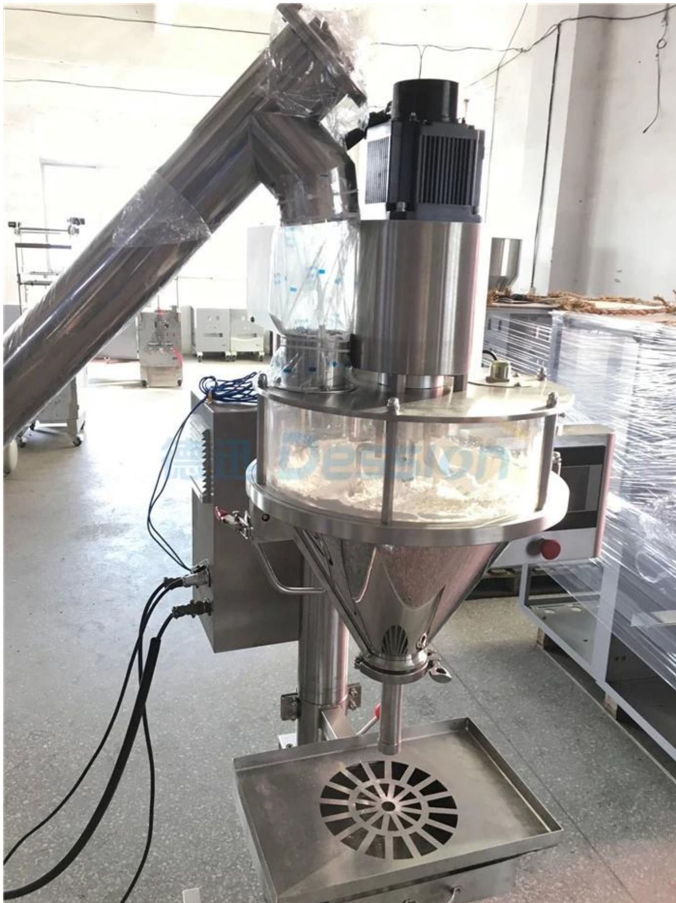
Alimentador de tornillo y medición de tornillo
