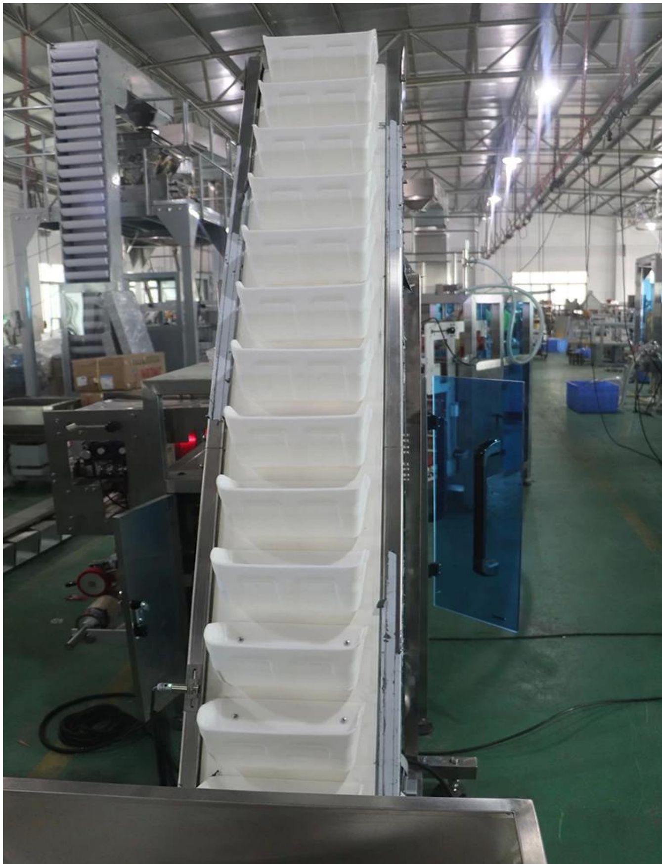
3) Nouilles tombant vers la trémie
