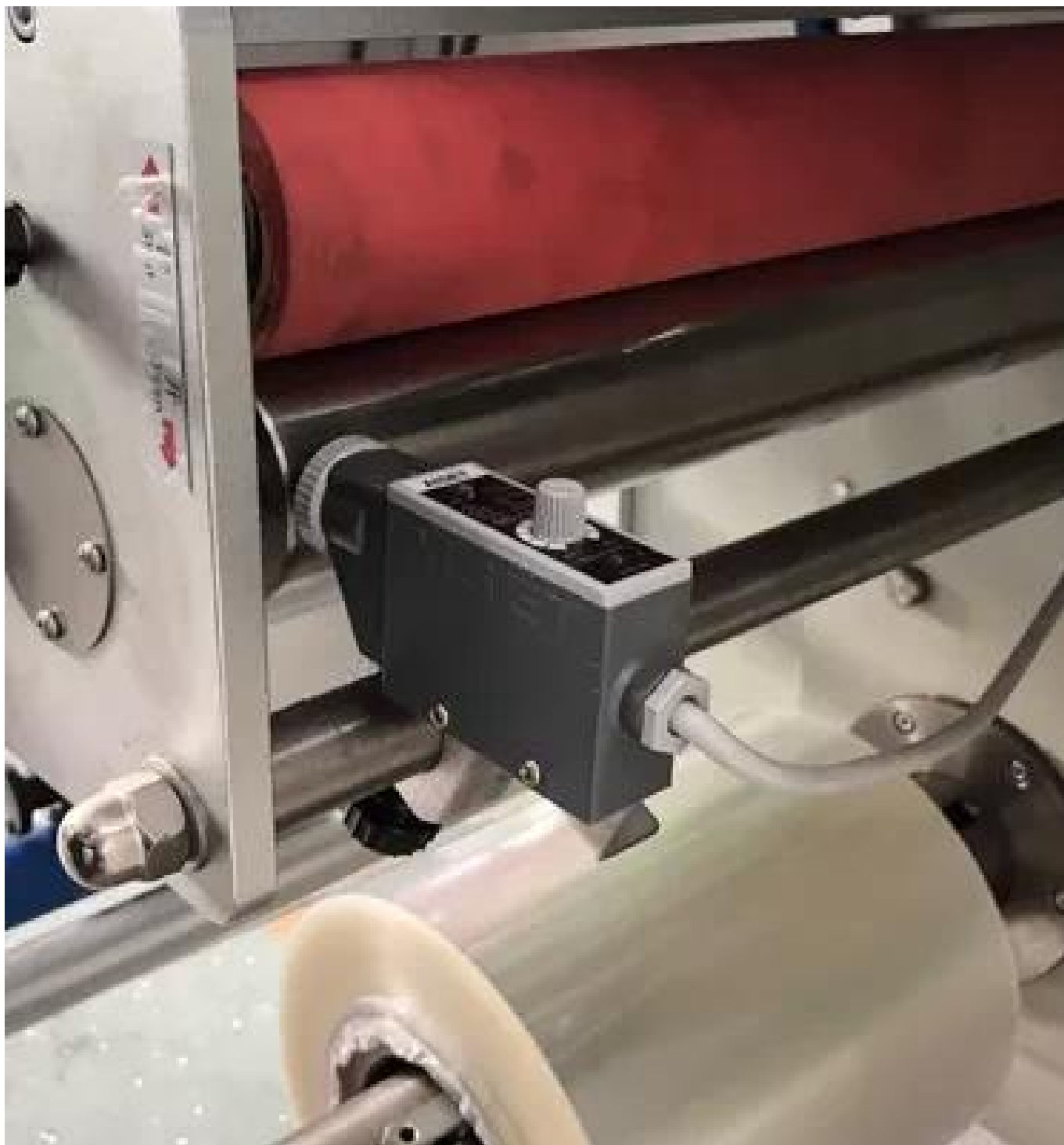
Sensor ocular de alta sensibilidad
