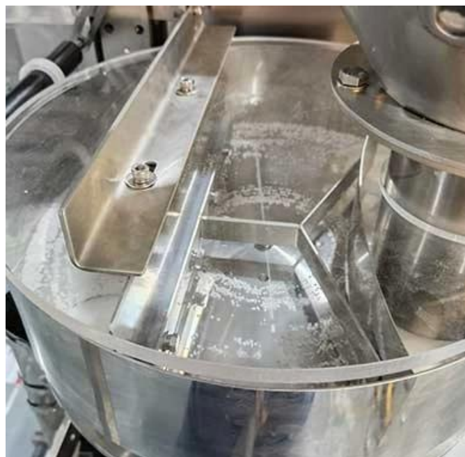
Dispositivo de copo medidor de alta precisão
