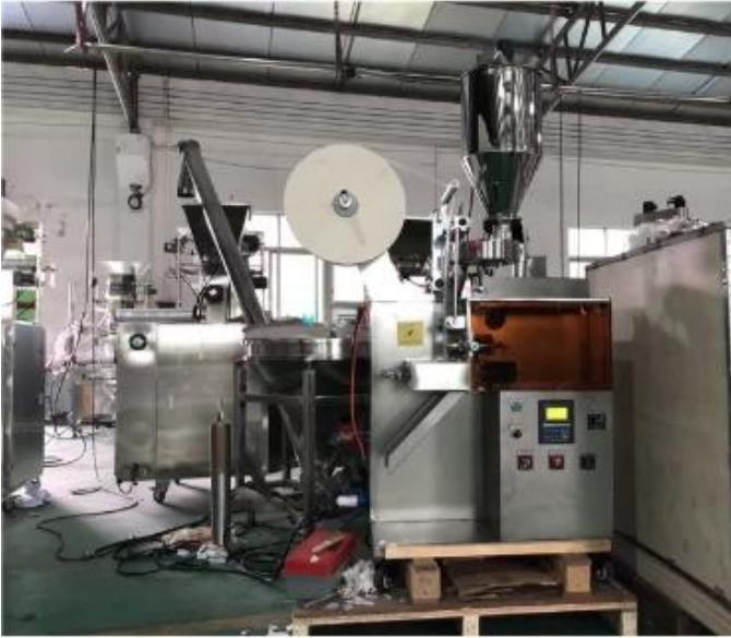
Parte frontal da máquina de embalagem snus
