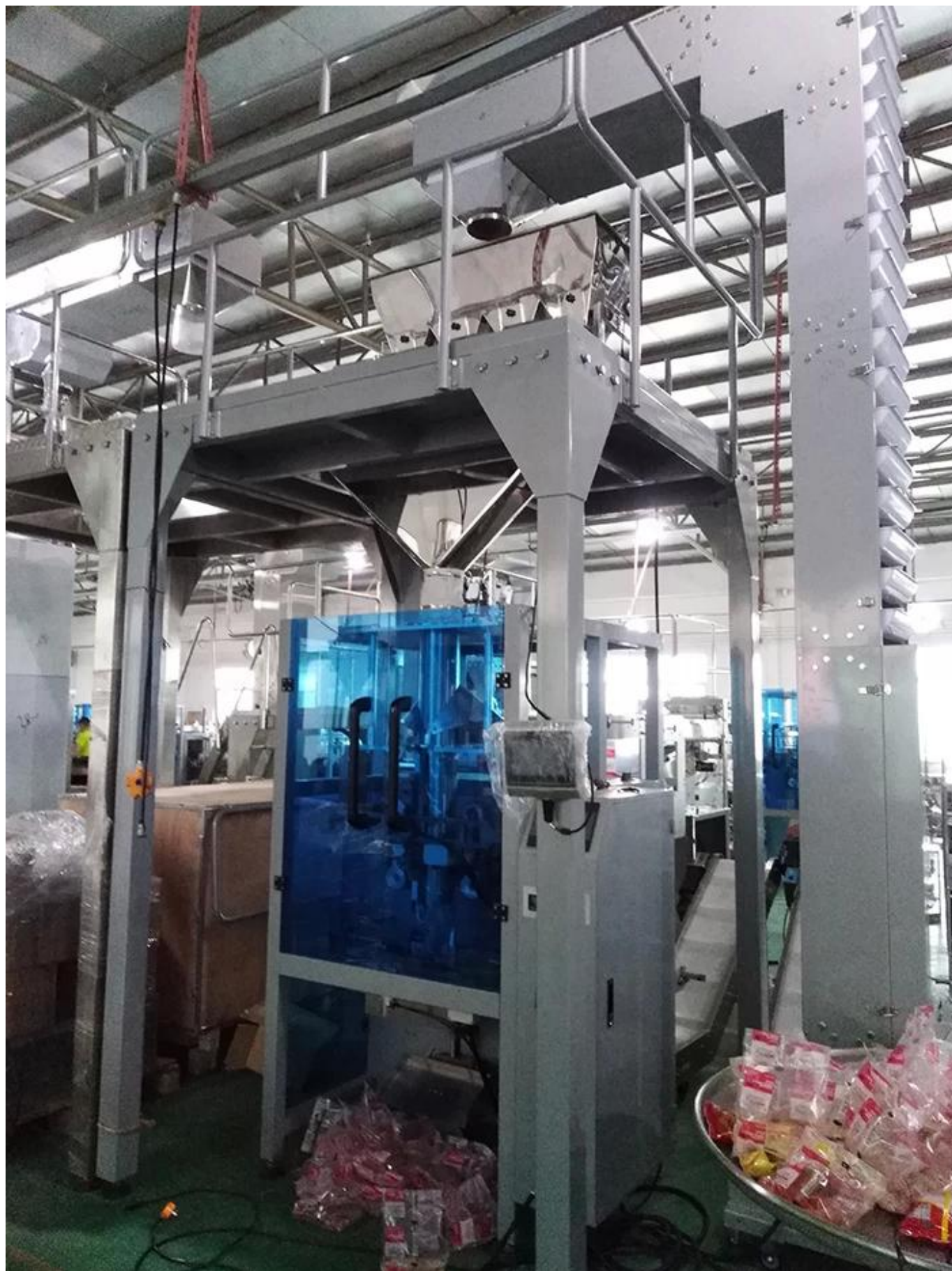
Colocar material no carregador Z
