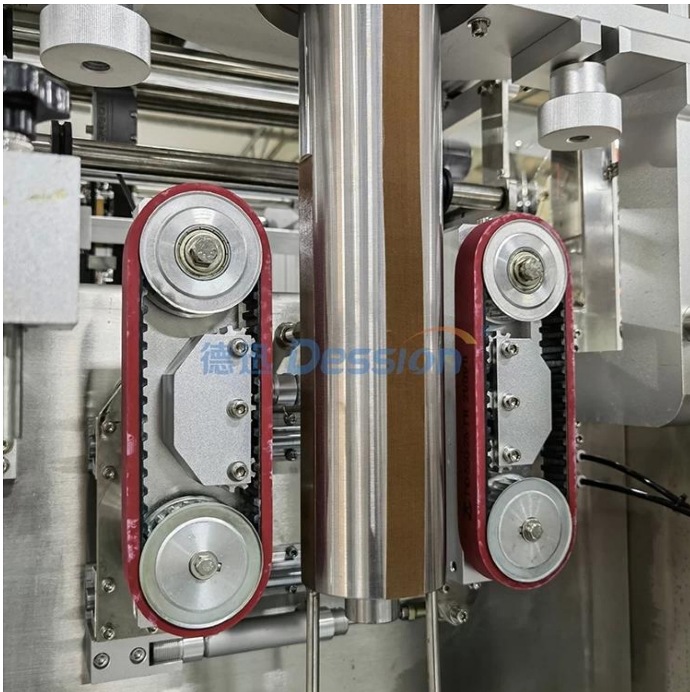
Уплотнительная часть и устройство для изготовления пакетов
