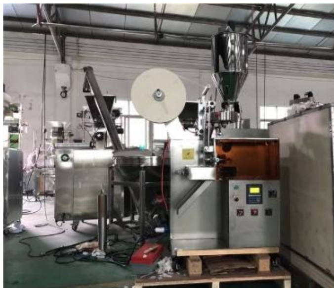
Передняя сторона упаковочной машины для снюса
