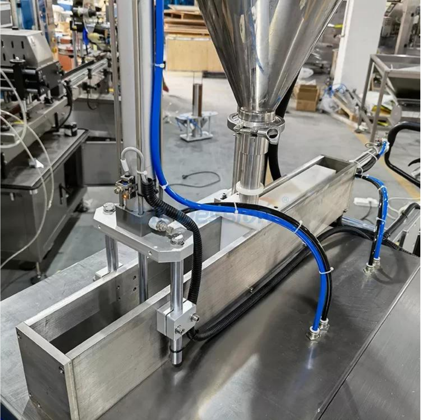
Pnömatik Pompa dolumu
