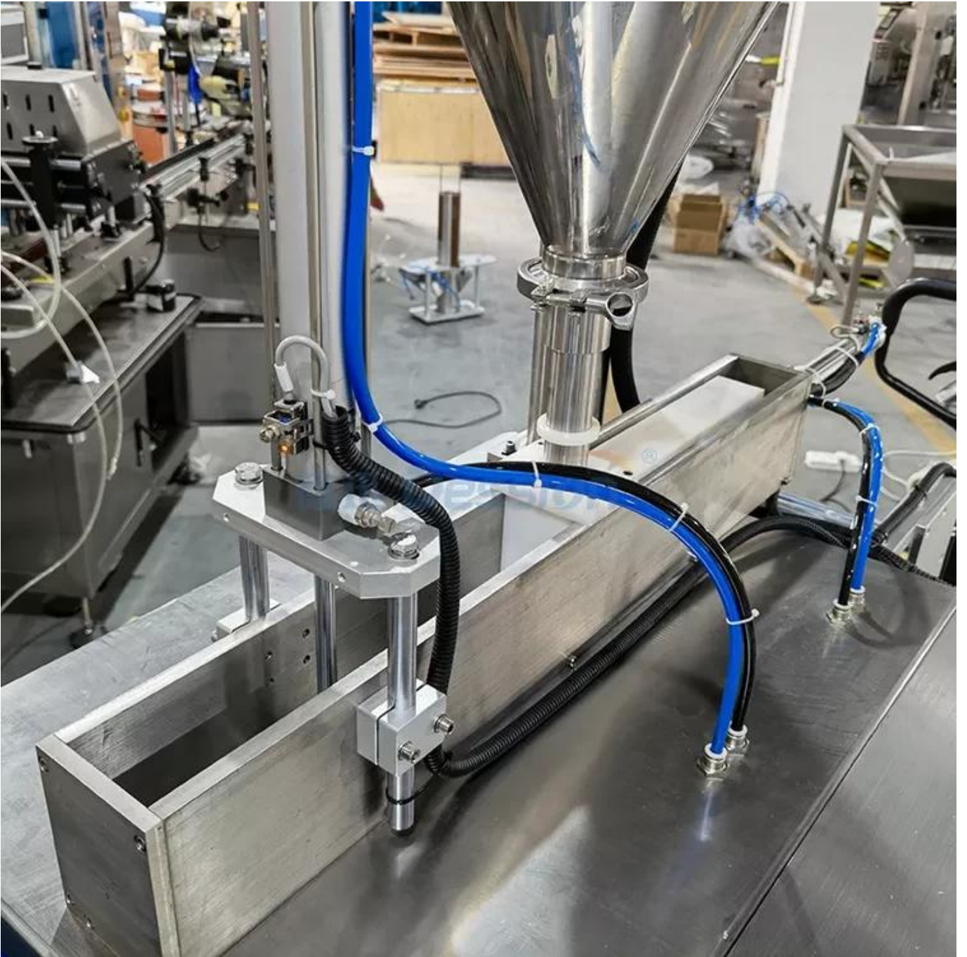
Pnömatik Pompa dolumu
